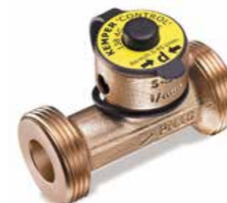
CONTROL-PLUS Durchfluss- und Temperaturmessarmatur, Figur 138 4G / GLT-Version Figur 138 6G Zur exakten Ermittlung von Volumenströmen und Temperatu- ren in Trinkwassersystemen. Druckverlustarmes Sensorgehäuse; min. Fließgeschwindigkeit 0,2 m/s; max. Fließgeschwindig- keit 2,5 m/s; Temperaturmessbereich 0 - 100 °C
